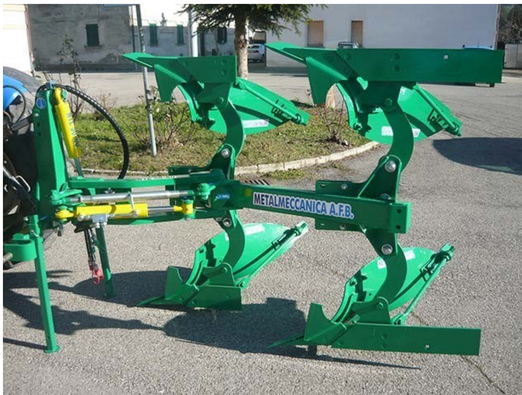
Fig. 26. aratro bivomere entro e fuorisolco reversibile idraulico 180°
